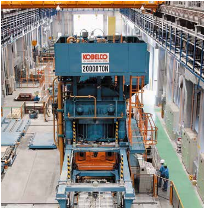
高端全自动 20000 吨冲压机
