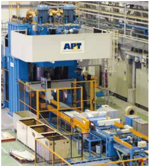
最新 4000 吨高速自动精密冲压机
